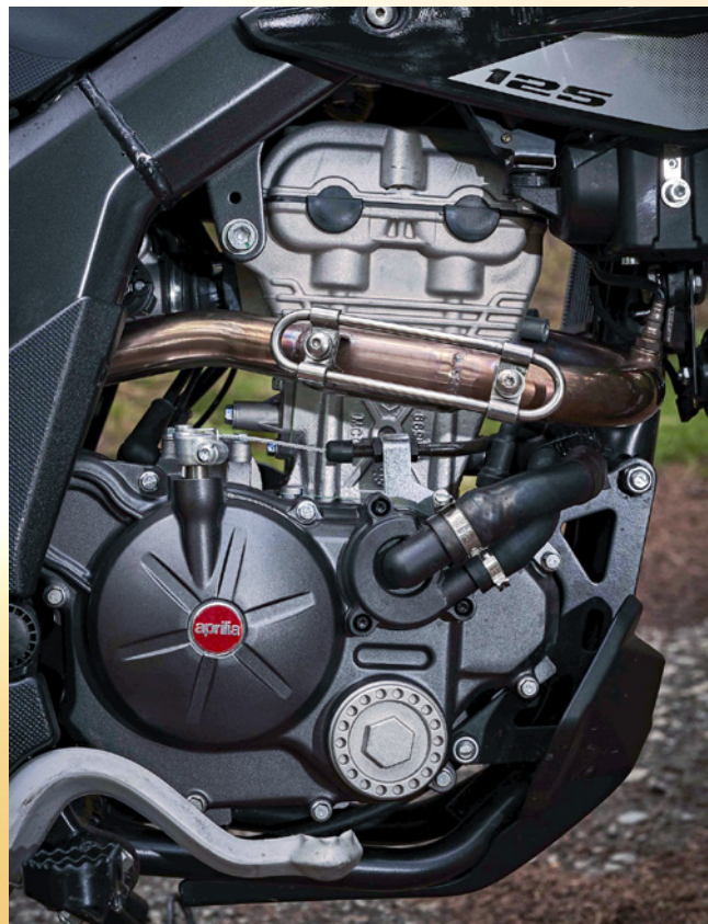
Moteur de l'Aprilia RX125: deux arbres à cames supérieurs, injection électronique de carburant, installés dans le Malaguti et le Mondial et produits sous licence en Chine
