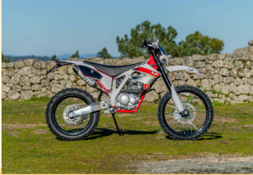
AJP PR4 125: Cadre combiné en alu et en acier, réservoir sous la selle
