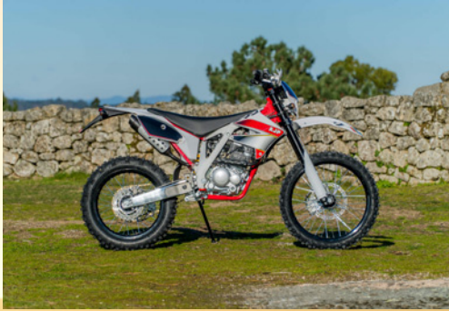
AJP PR4 125: Verbundrahmen aus Stahl und Alu, Tank unter der Sitzbank
