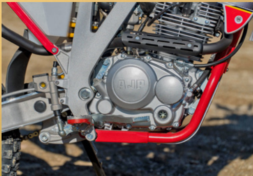
Einfacher, luftgekühlter Motor mit Vergaser an der portugiesischen Marke AJP
