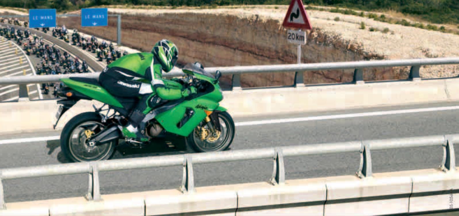
Die aerodynamischste Ninja aller Zeiten • 636cm<sup>3</sup> • Flüssigkeitsgekühlter 4-Zylinder-Viertakt-Reihenmotor • elektronische Benzineinspritzung • 130 PS (136 PS mit Ram Air) bei 14.000 1/min • 164 kg Trockengewicht • CHF 15.490,-
